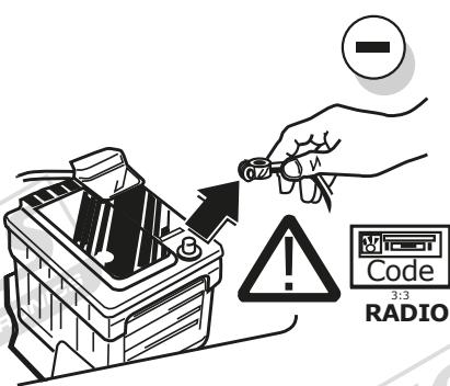
**DE** Um Störungen und Schäden am Bordnetz zu vermeiden, muss die Massepolklemme unbedingt vor Beginn aller Arbeiten von der Fahrzeughilfsbatterie getrennt werden! Insbesondere bei Arbeiten und Anschlüssen am CAN-Datenbus kann bei nicht abgeklemmter Batterie sowohl das Anhängermodul als auch das fahrzeugeigene Bordnetzsteuergerät beschädigt werden! Bitte Herstellervorschriften beim Ab- und Anklemmen der Fahrzeughilfsbatterie beachten!
